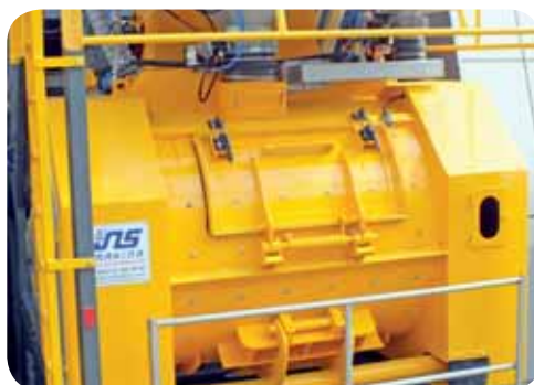
SERVICE GATE WITH SPRING AND SHOCK ABSORBER. ПРУЖИННО АМОТИЗИРОВАННАЯ КРЫШКА ОБСЛУЖИВАНИЯ
