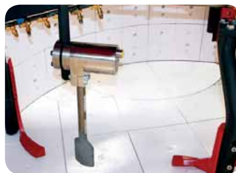
MOISTURE MEASUREMENT SYSTEM WITH COL- LECTOR AND HIGH SENSITIVITY. ГИГРОМЕТР ВЫСОКОЙ ТОЧНОСТИ С ВРАЩАЮЩЕМСЯ КОЛЛЕКТОРОМ
