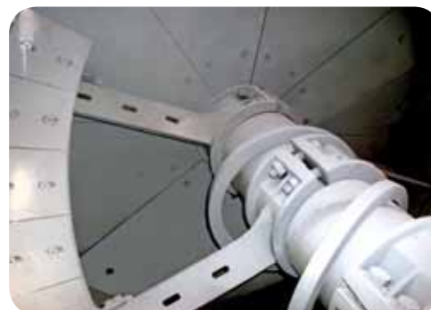
STEEL CAST ARMS, PALLETS WITH DOUBLE SCREW, COVERED SHAFT, RINGS. ЛИТЫЕ РЫЧАГИ, ДВУХБОЛТОВЫЕ ПЛИТЫ, ПОКРЫТЫЙ ВАЛ
