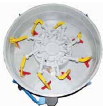
SPRING PALLETS ON FRAME FOR HOMOGENOUS MIXING ВОКРУГ КОРПУСА РАСПОЛОЖЕНЫ УПРУГИЕ РЫЧАГИ ДЛЯ ОДНОРОДНОГО СМЕШИВАНИЯ
