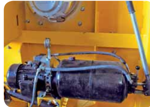
HYDRAULIC DISCHARGE GATE, AND MANUAL ARM FOR OPENING ГИДРАВЛИЧЕСКАЯ НИЖНЯЯ КРЫШКА, ТАКЖЕ ОТКРЫВАЕМАЯ ВРУЧНУЮ
