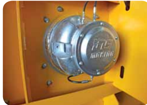
LEAKPROOF STEEL CAST BEARINGS. ПОДШИПНИКИ КАЧЕНИЯ ИЗ БРОНЗЫ ОБЕСПЕЧИВАЮТ ГЕРМЕТИЧНОСТЬ
