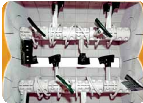
FOR MIXERS. MOVABLE CLEANING CIRCLES ON SHAFT. ДВИЖУЩИЕ КОЛЬЦА ВАЛА НА МИКСЕРЕ
