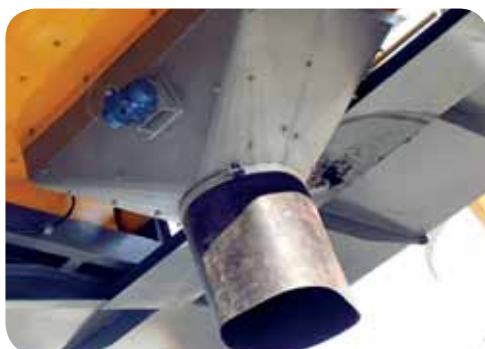
VIBRATING BOTTOM DISCHARGE CHUTE WITH LININGS PLAQUE D'USURE ET GOULOTTE DE DECHARGEMENT VIBRANTE INFÉRIEURE DU BÉTON
