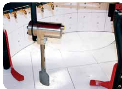
MOISTURE MEASUREMENT SYSTEM WITH COLLECTOR AND HIGH SENSITIVITY. SYSTÈME DE MESURE D'HUMIDITÉ À HAUTE PRÉCISION AVEC COLLECTEUR TOURNANT
