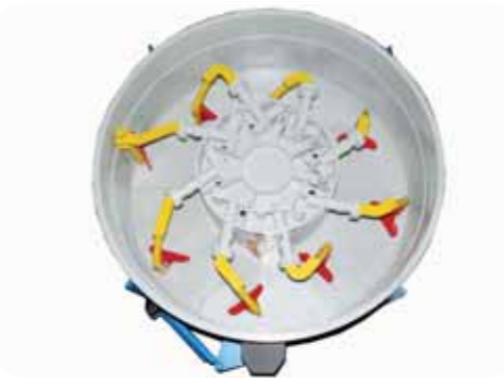
SPRING PALLETS ON FRAME FOR HOMOGENOUS MIXING PALETTES À RESSORT POUR MALAXAGE HOMOGENE AUTOUR DU CORPS
