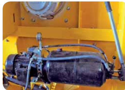
HYDRAULIC DISCHARGE GATE, AND MANUAL ARM FOR OPENING SYSTÈME DE TRAPPE INFÉRIEURE HYDRAULIQUE ET POIGNÉE DE TRAPPE MANUELLE
