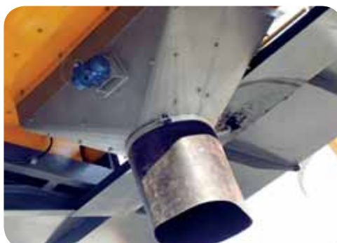
VIBRATING BOTTOM DISCHARGE CHUTE WITH LININGS PLAQUE D'USURE ET GOULOTTE DE DÉCHARGE VIBRANT INFÉRIEURE DU BÉTON
