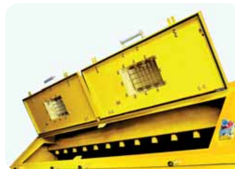
MIXER INSPECTION HATCHES HOMOGENOUS WATER DISTRIBUTOR. TRAPPES D'ENTRETIEN DE MALXEUR SYSTÈME DE DISTRIBU-TION DE L'EAU DANS LE MALXEUR D'UNE MANIÈRE ÉGALE
