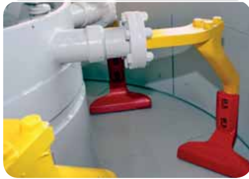
REMOVABLE CAST STEEL MIXING ARMS BRAS DU MALAXEUR EN FONTE DÉTACHABLE
