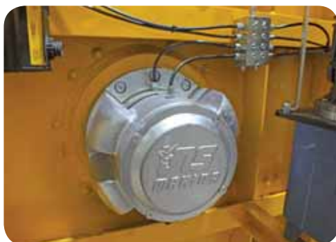
LEAKPROOF STEEL CAST BEARINGS. ROULEMENT EN FONTE ETANCHE AVEC ESPACE INTERMEDIAIRE
