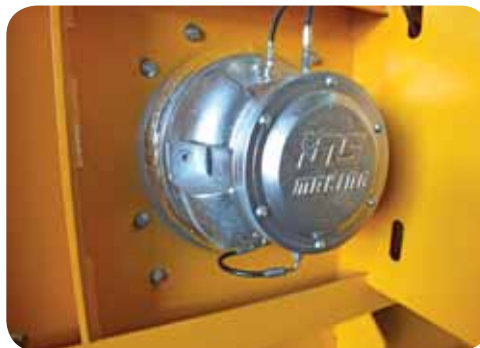
LEAKPROOF STEEL CAST BEARINGS. ROULEMENT EN FONTE ÉTANCHE AVEC ESPACE INTERMÉDIAIRE
