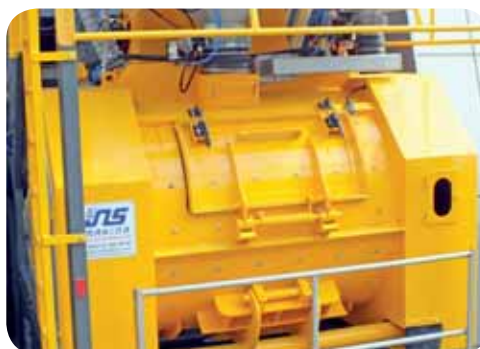
SERVICE GATE WITH SPRING AND SHOCK ABSORBER. TRAPPE DE SERVICE LARGE AVEC RESSORT AMORTISSEUR
