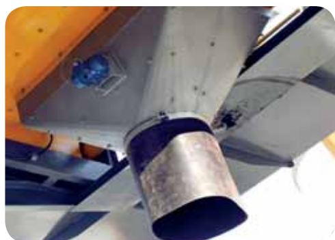
VIBRATING BOTTOM DISCHARGE CHUTE WITH LININGS PLAQUE D'USURE ET GOULOTTE DE DÉCHARGEMENT VIBRANT INFÉRIEUR DU BÉTON
